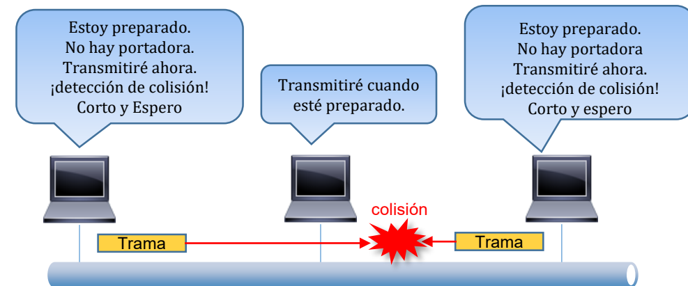
Acceso mediante detección de portadora y colisión
