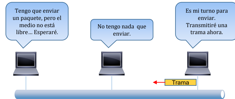
Acceso mediante detección de portadora
